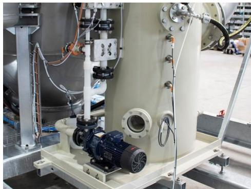
Bauteile für Schwefelsäure- und Brüdenwäscher komplett **aus PE/PP**, dadurch langlebig und korrosionsfrei.
